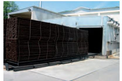
**In großen Öfen werden die Hölzer für die Redecker-Thermoholz-Produkte einen Tag lang erhitzt.**
