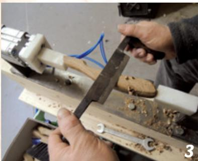
3 Mit traditionellen Werkzeugen werden die Rohlinge in Form gebracht, ohne die Holzoberfläche weiter zu behandeln.
