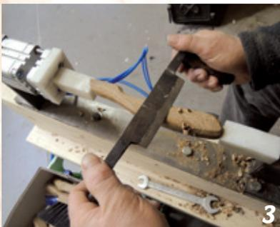
3 Les ébauches sont mises en forme au moyen d'outils traditionnels sans traitement ultérieur de la surface en bois.
